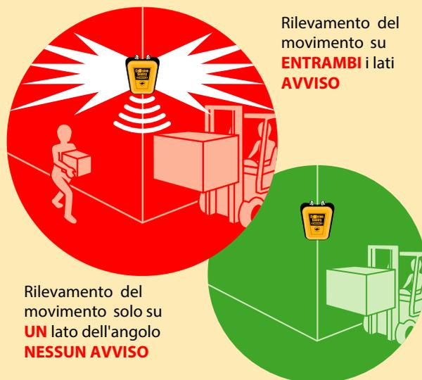
*Il Collision Sentry Corner Pro emette un allarme SOLO quando rileva un movimento in entrambe le zone di rilevamento; dunque un movimento su entrambi i lati dell'angolo cieco. In questi casi, il Collision Sentry Corner Pro lampeggia in entrambe le direzioni ed emette un segnale acustico, dando il tempo necessario per un'azione correttiva.*
